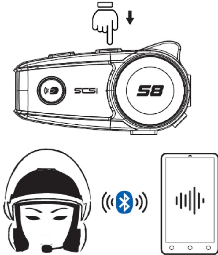
Cuando su S8 esté emparejado con el teléfono, presiona de forma corta el botón de Volumen + dos veces, así encenderá automáticamente la función de comando de voz.
