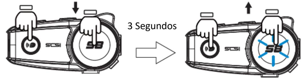
Presione el botón Intercomunicador + Función durante 3 segundos hasta que el indicador LED parpadee con luz azul, se escuchará un mensaje de voz "Bienvenido al sistema de comunicación Bluetooth".
