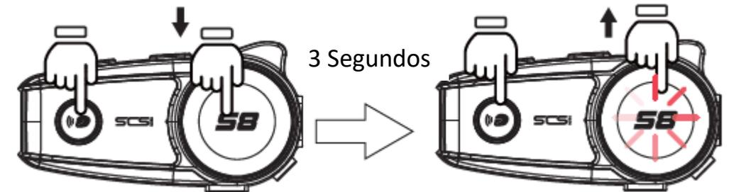
Cuando el dispositivo esté encendido, presione el botón Intercomunicador + Función durante 3 segundos hasta que el indicador LED parpadee en rojo, se escuchará el mensaje de voz "Apagar".
